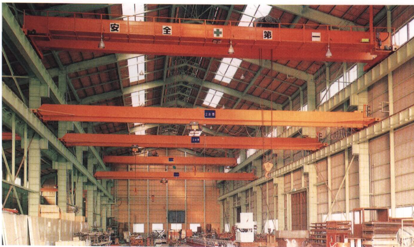
架空式起重機 (10t, 2.8t SPAN 20M RUNWAY 60M) 華益工業屏東廠實攝
