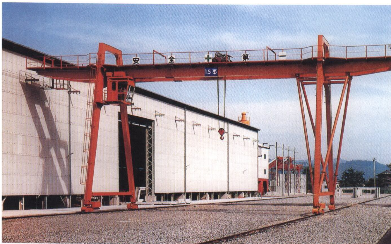
門型起重機 (15t SPAN 20M+5M+5M) 億承工程彰化廠實攝
