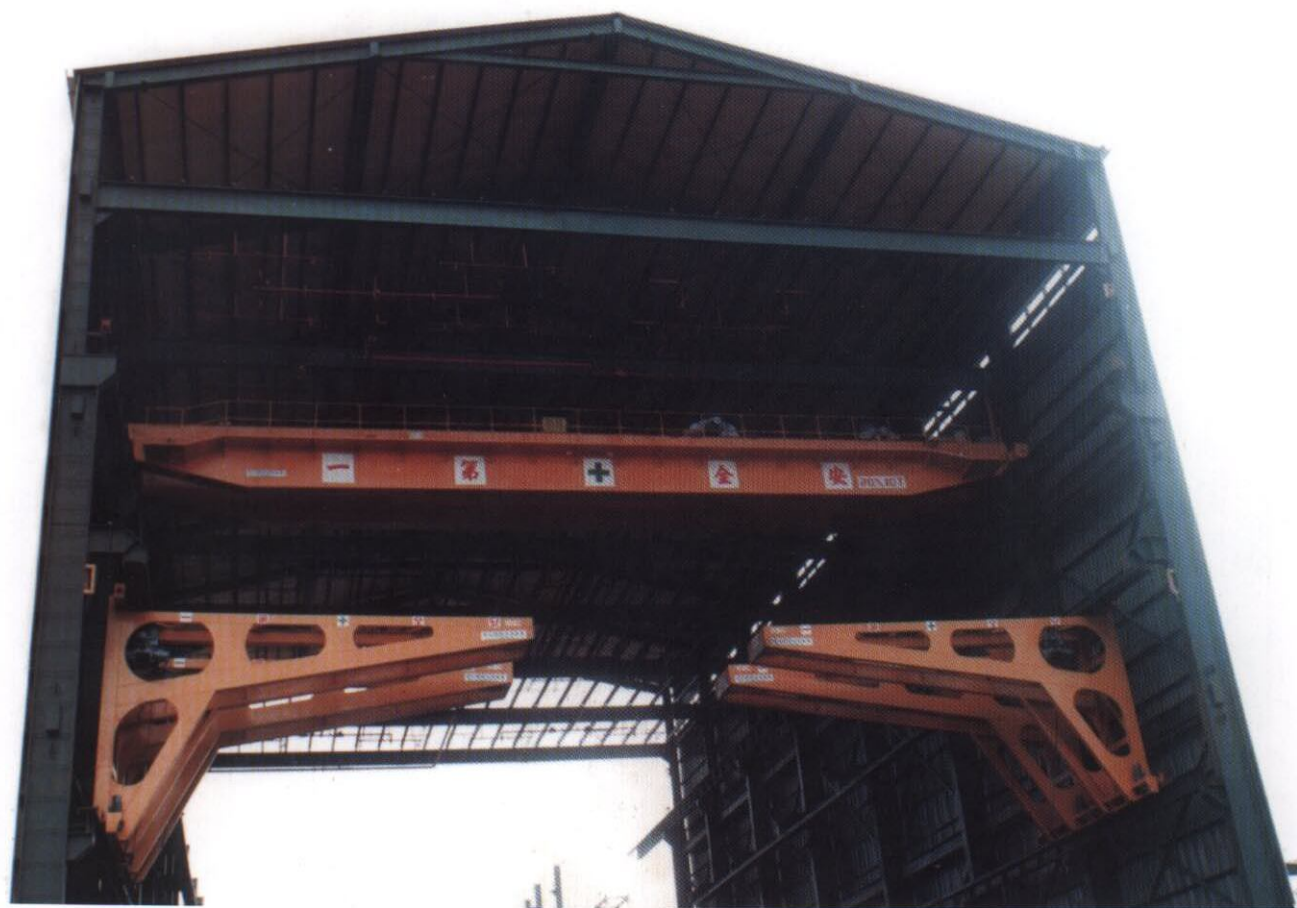
架空及附壁式天車 (30t SPAN 30M/2.8t SPAN 7M) 林盛造船旗津廠實攝
