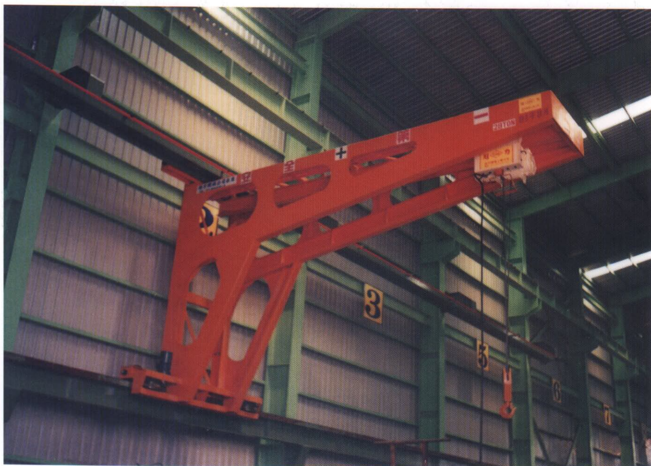
附壁式 (WALL CRANE) 荔盈鋼鐵燕巢廠實攝 (5T×7M)
